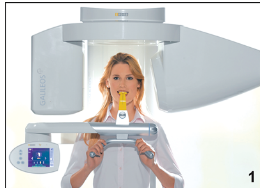
Abb. 1: Der 3D-Scan des gesamten Schädelvolumens dauert nur 14 Sekunden; der Patient kann dabei stehen oder sitzen.
